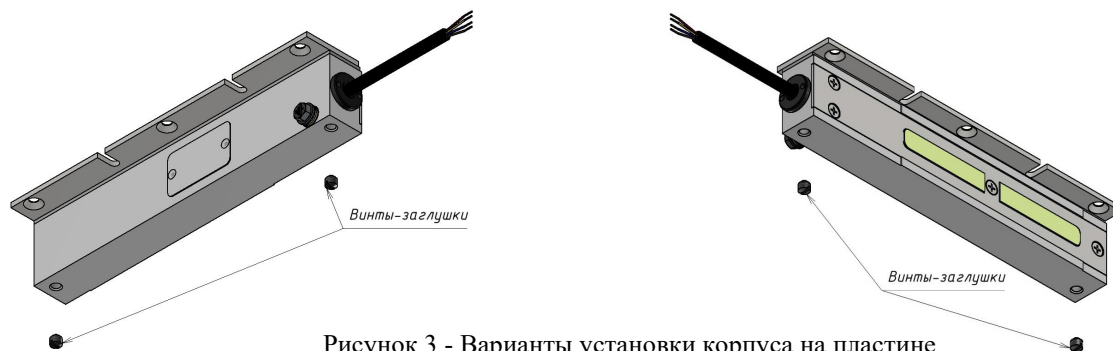
Рисунок 3 - Варианты установки корпуса на пластине
